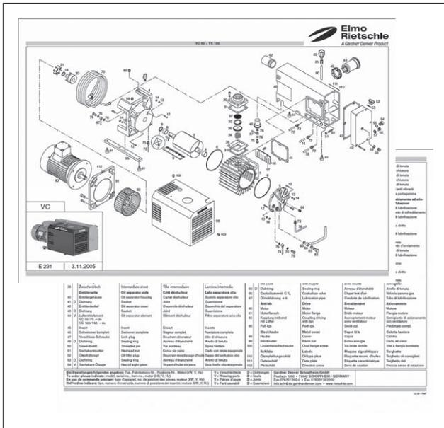
Fig. 9 Ersatzteilliste (Beispiel)
